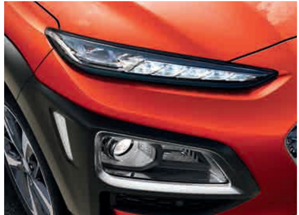
Voll-LED-Scheinwerfer mit statischem Kurvenlicht und LED-Tagfahrlicht
